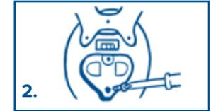
2. Utiliza un destornillador phillips/de cruz para aflojar el tornillo en la tapa de las pilas.
